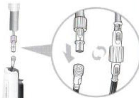
3. Una el mango al cuerpo principal. (La parte abultada o pin de la parte inferior del mango encajará en la parte superior del cuerpo principal)
