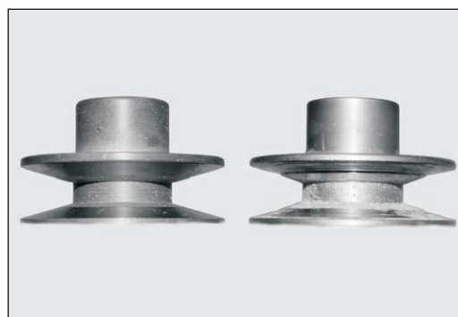
Fig. 34 A mano izquierda se ve una polea de correas nueva, a mano derecha una polea desgastada que debe ser cambiada.
