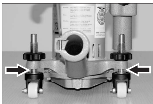
Fig. 33 Después de montar el nuevo rodillo guía, deberá suceder el ajuste (véase la sección 6.9).
