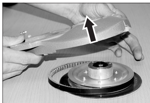
Fig. 22 Aleje la correa trapezoidal, coloque la nueva y ...
